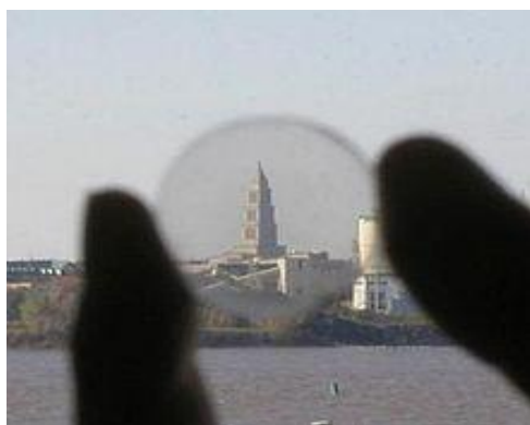
شکل 11- گذردهی نوری در آلومینا ( Al_2O_3 ) از شفاف تا مات (سمت راست)
